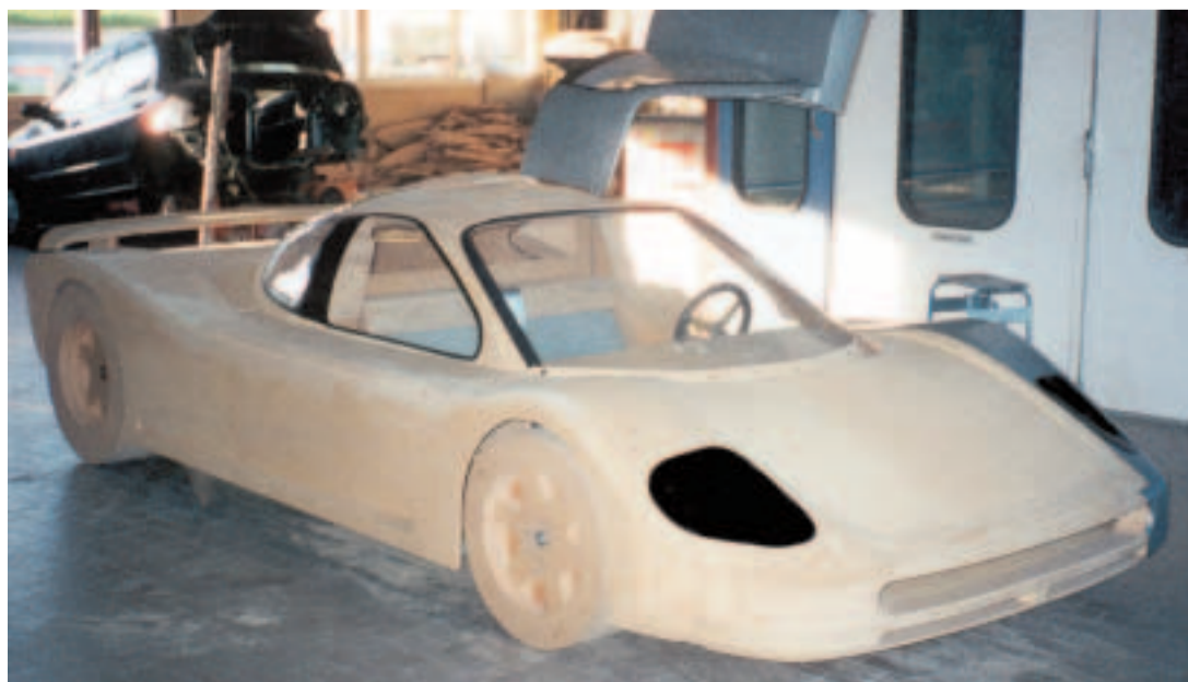
Après le design, Jean-Pierre Pidoux s'est mué en menuisier pour réaliser une maquette en bois au 1:1.
