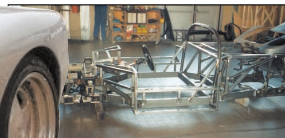
LE CHÂSSIS En tube d'acier.
